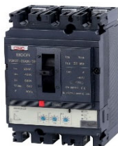
Intrerupător automat M3E Electronic I r =I n (1-0,4) I sd =I n (2-12) I i =I n (4-14) ajustabil
