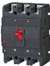
Intrerupător automat M8RT Thermal and magnetic I r =I n (1-0,8) I sd =I n (5-10) ajustabil
