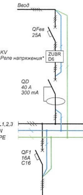
\* Для корректной работы ZUBR D6 достаточно подключения нуля на одну из нулевых клемм (4 или 8).
