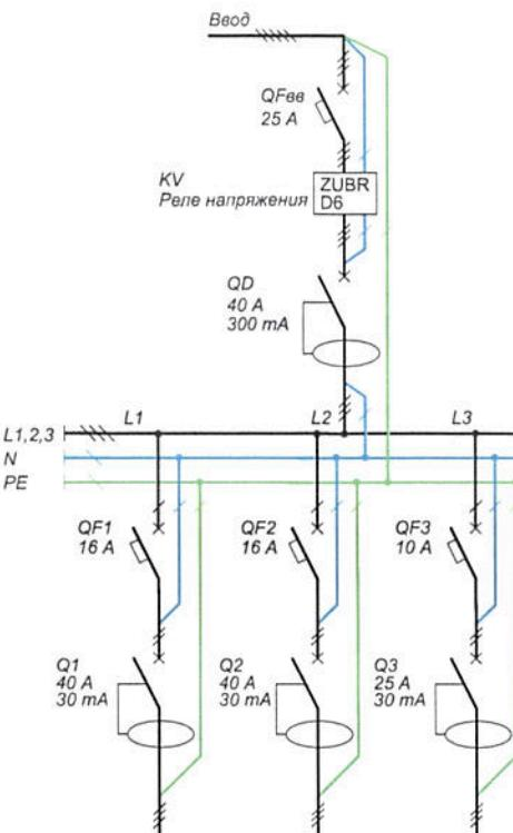
Схема 2. Вариант подключения УЗО, автоматического выключателя с транзистором нуля через устройство к трем однофазным нагрузкам
